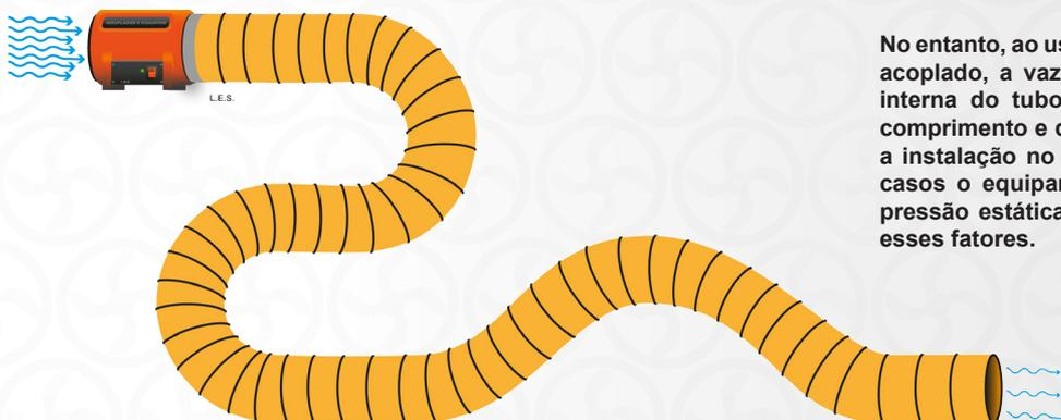
No entanto, ao usar o ventilador com um duto acoplado, a vazão dependerá da superfície interna do tubo, do seu diâmetro, do seu comprimento e das dobras necessárias para a instalação no local de trabalho. E nesses casos o equipamento deverá oferecer uma pressão estática adequada para compensar esses fatores.
