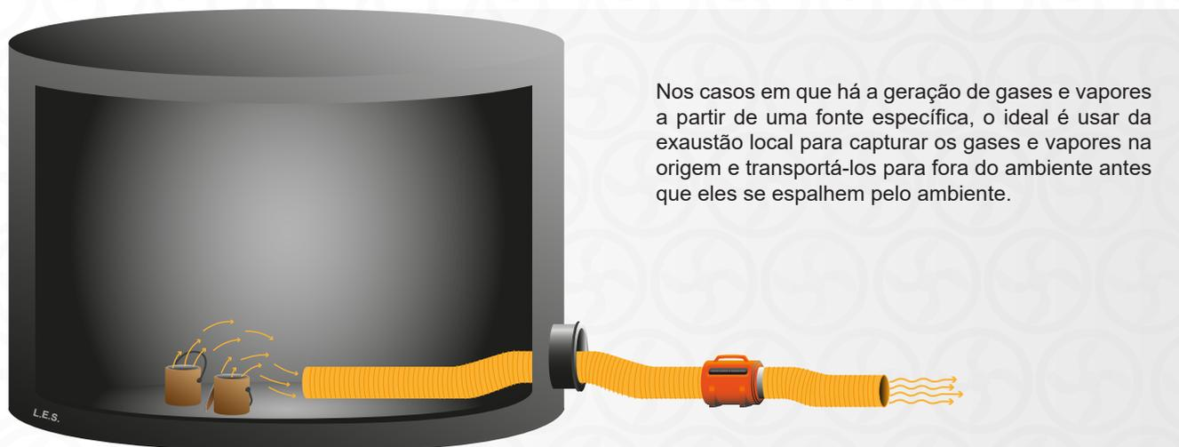
Nos casos em que há a geração de gases e vapores a partir de uma fonte específica, o ideal é usar da exaustão local para capturar os gases e vapores na origem e transportá-los para fora do ambiente antes que eles se espalhem pelo ambiente.
