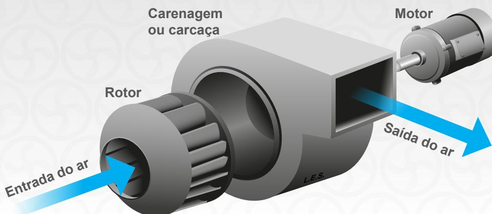
Esse tipo de ventilador recebe esse nome por usar a força centrífuga para descolar o ar. Assim como acontece numa máquina de lavar roupa, cujo tambor interno gira em alta velocidade para forçar a água a sair da roupa, a peça do ventilador denominada de rotor age de uma forma semelhante para mover o ar.
