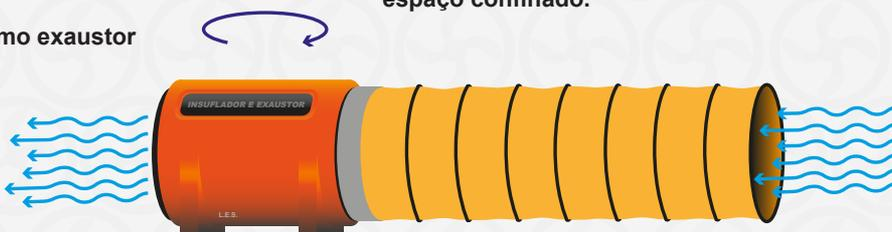
Invertendo-se a posição do ventilador axial ele passa a funcionar como exaustor, ou seja, suga o ar de dentro do espaço confinado.
