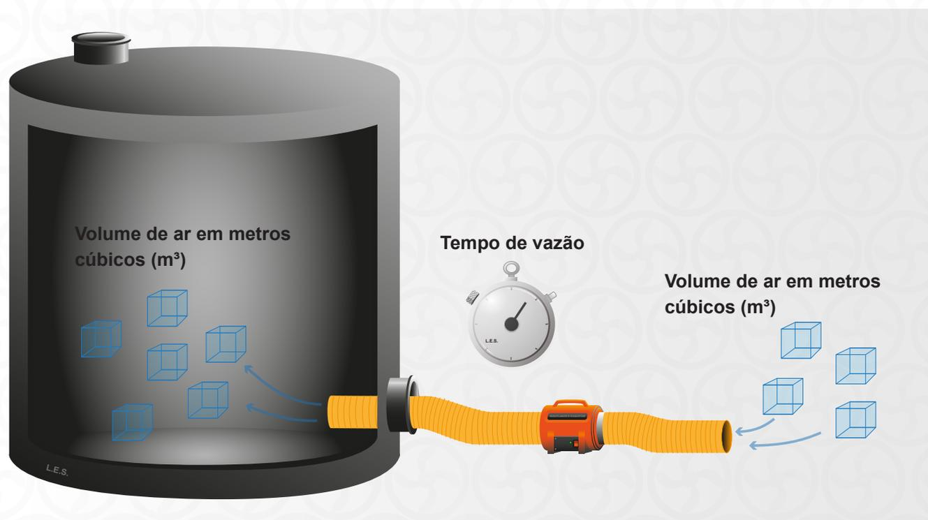
Os fabricantes e os importadores dos equipamentos de ventilação devem informar a capacidade de vazão dos equipamentos que fornecem. Alguns fornecem a capacidade de vazão em metros cúbicos por minuto ( $\text{m}^3/\text{min}$ ), mas a maioria utiliza a unidade de metros cúbicos por hora ( $\text{m}^3/\text{h}$ ).
