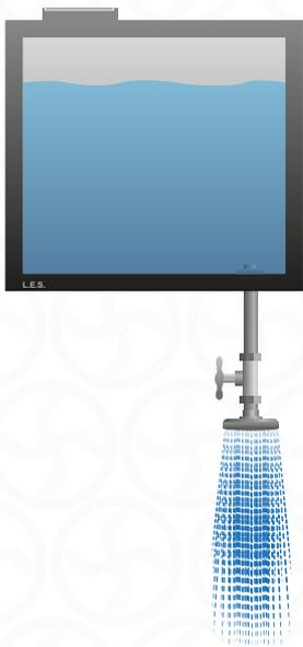
Ao abrir a válvula do chuveiro a pressão estática se tornará pressão dinâmica e ocorrerá o início da vazão da água da caixa d'água para o chuveiro e do chuveiro para o meio externo. Com o sistema oferecendo pouca resistência e sem grandes obstáculos, essa vazão será boa, ou seja, fluirá por ele um bom volume de água a cada segundo em que o sistema estiver aberto.
