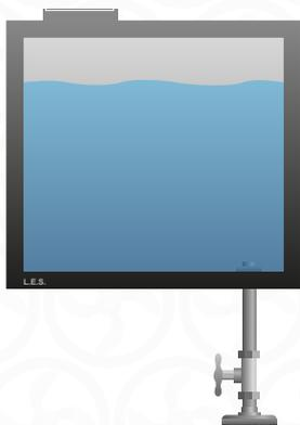
Esta ilustração representa um sistema que apresenta uma pressão estática, com base na ação da gravidade e no volume de água parada na caixa d'água e no encanamento.
