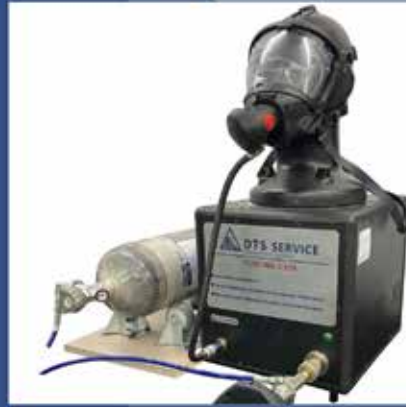
Ferramenta Service PosiCHECK (DTS Service com laudo computadorizado)
