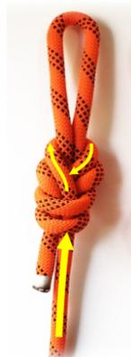
Uma literatura francesa da década de 80 mencionava que a posição da volta sob tensão pode gerar um ganho de resistência de até 10%. Tal informação foi confirmada nos ensaios, que demonstraram um ganho de **7,7%** calculado sobre os valores médios de resistência das amostras.
