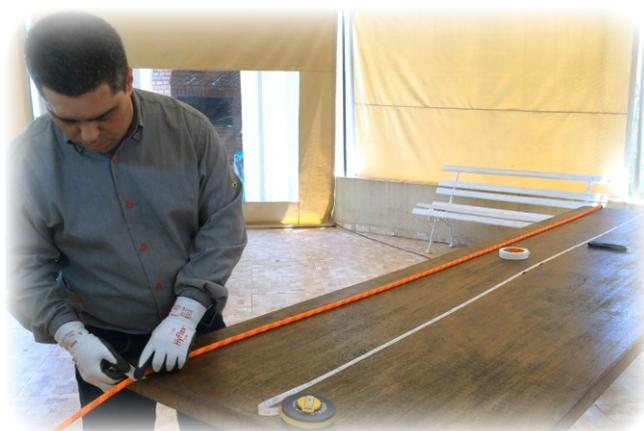
As cordas contínuas geraram amostras de 3 metros de comprimento, medidas, cortadas e com o acabamento de pontas.
